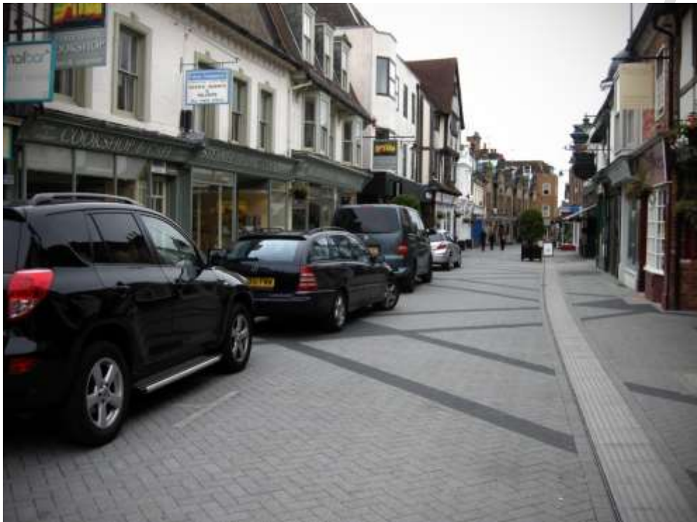
Figure 21 : Naked street dans East Street in Horsham, Sussex, UK – Le principe est d'ôter toute signalisation. Ce principe a été développé aux Pays-Bas et s'est exporté internationalement (source image : streetswithoutcars)
